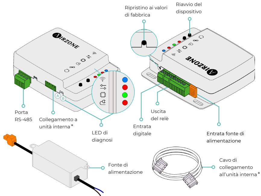
\* Nota: sia la forma del morsetto sul dispositivo Aidoo Pro che la forma del cavo possono variare a seconda del costruttore compatibile.
