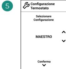
**Maestro:** Permette di controllare tutti i parametri dell'impianto.
