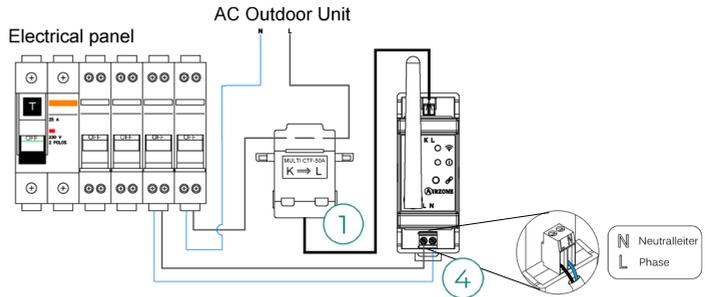
Der Netzanschluss für die Spannungsversorgung des Moduls **4** erfolgt über eine 2-polige Klemme. Schließen Sie die Kabel unter Beachtung der Polarität an der Schraubklemme an.
