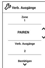
Das System erlaubt die Zuweisung von mehr als einem Steuerausgang zu einer Zone, falls erforderlich. Dadurch können mehrere Steuerausgänge von einem einzigen Thermostat aus angesteuert werden. Standardmäßig wird der erste freie Ausgang gewählt. Wenn kein Ausgang gewählt wird, erscheint bei Bestätigung die Meldung „Zone ohne verbundene Ausgänge“ und es ist möglich, im Menü zurückzugehen.
