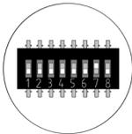
Wählen Sie die dem Thermostat zugewiesene Zone, indem Sie den entsprechenden DIP-Schalter hochschieben.
