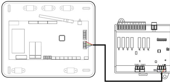
Die potenzialfreien Steuerrelais ①②③④⑤ sind für 24/48 VAC ausgelegt. Für die Ansteuerung von Elementen mit höherer Leistung empfehlen wir den Einsatz von entsprechend ausgelegten Leistungsschützen.
