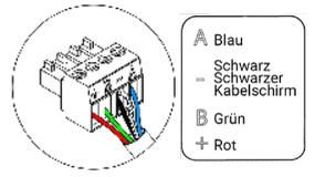
**Wichtig:** Bei Elementen mit externer Spannungsversorgung 110/230 VAC müssen lediglich die Pole „A“, „B“ und „Schirm“ des Kommunikationsbusses angeschlossen werden. Schließen Sie den Kabelschirm lediglich am Anschluss der Systemzentrale an.
