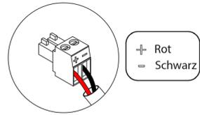
Für den Anschluss der Stellmotorausgänge stehen 8 2-polige Klemmen zur Verfügung. Schließen Sie die Kabel unter Beachtung der Farbcodierung an der Schraubklemme an.
