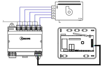
Anlage mit 4-Rohrsystem
