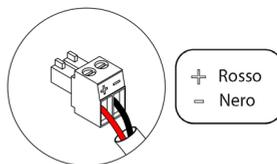
Dispone di 8 morsetti a 2 pin per il collegamento delle uscite del motore. Fissare i cavi con le viti del morsetto rispettando il codice dei colori.
