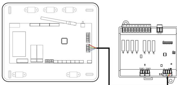
Le caratteristiche dei relè di controllo sono ①②③④⑤ 24/48 VAC senza alimentazione. Per controllare elementi di potenza maggiore, si consiglia l'uso di contattori della potenza da controllare.
