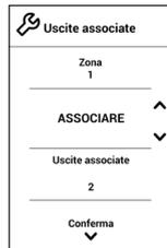
Il sistema permette di associare a una zona più di una uscita di controllo in caso di necessità. È possibile gestire varie uscite di controllo da un unico termostato. Per difetto, verrà selezionata la prima uscita libera. In caso di mancata selezione, alla conferma verrà visualizzato l'avviso "Zona senza uscite associate" e sarà possibile tornare indietro.
