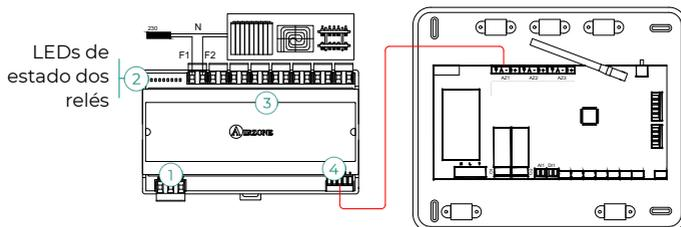
As características dos relés de controlo ③ são Imáx: de 10 A a 110/230 VAC livre de tensão. Para controlar elementos de maior potência, recomenda-se o uso de contactores da potência que se quer controlar. Lembre-se de ligar o neutro diretamente do circuito até ao elemento que pretende controlar.
