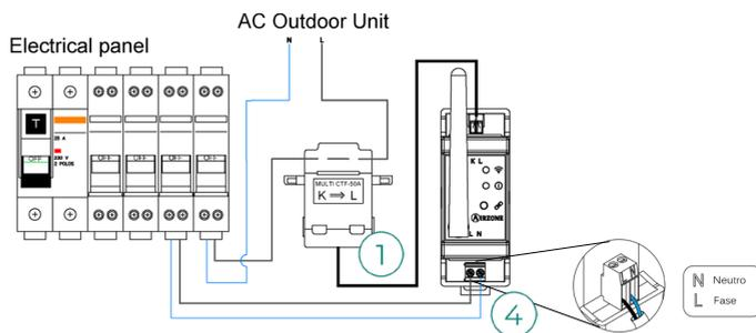
A ligação da alimentação elétrica ao módulo ④ é feita com um borne de 2 pinos. Fixe os cabos com os parafusos do borne respeitando a sua polaridade.
