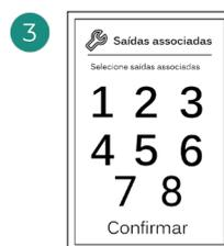
O sistema permite associar mais de uma saída de controlo a uma zona, em caso de necessidade. É possível gerir várias saídas de controlo a partir de um único termostato.
