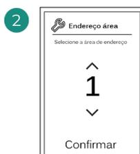
Selecione a zona associada a este termostato. À cada zona corresponde uma saída de controlo (saída para motor ou relé de controlo de elementos radiantes).
