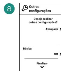
Finalize o processo. A partir Airzone Cloud, aceda à configuração avançada e/ou ative a \*função básica (esta última permite ligar/desligar, ajuste da velocidade, ajuste do modo de funcionamento e ajuste da temperatura).
