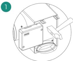
Com um golpe seco, retire a área pré-cortada das laterais correspondentes ao bypass.
