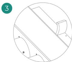
Certifique-se de isolar o encaixe de ligação. Utilize faixas de material isolante (lã de vidro ou de espuma de polietileno) de 25 mm de espessura. A largura destas faixas de isolamento é de 97 mm para o pleno motorizado Standard, Medium e de 37 mm para o pleno motorizado Slim.
