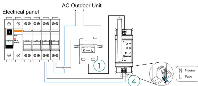
A ligação da alimentação elétrica ao módulo (4) é feita com um borne de 2 pinos. Fixe os cabos com os parafusos do borne respeitando a sua polaridade.
