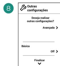
Finalize o processo. A partir Airzone Cloud, aceda à configuração avançada e/ou ative a \*função básica (esta última permite ligar/desligar, ajuste da velocidade, ajuste do modo de funcionamento e ajuste da temperatura).
