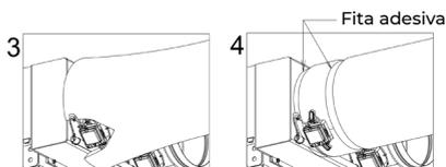
Ligue a conduta de cada zona com a sua correspondente comporta. Siga as instruções para um isolamento adequado. Faça um corte na conduta para manter o motor fora.
