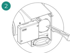
Com uma lâmina, retire o isolante que cobre a zona do bypass e descubra as suas ranhuras de fixação.
