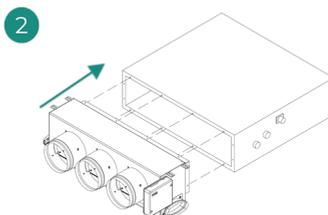
Posicione o Easyzone na boca de impulsão da unidade e fixe-o com parafusos.
