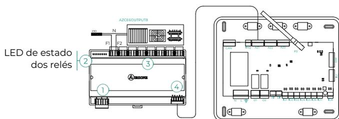
As características dos relés de controlo (3) são Imáx: de 10 A a 110/230 VAC livre de tensão. Para controlar elementos de maior potência, recomenda-se o uso de contactores da potência que se quer controlar. Lembre-se de ligar o neutro diretamente do circuito até ao elemento que pretende controlar.
