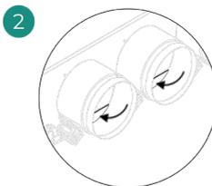
Retire o encaixe elíptico fixado com parafusos. Retire a chapa de proteção que cobre a entrada de ar exterior e fixe novamente o encaixe elíptico.
