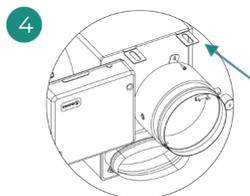
Fixe o registo de bypass no pleno com um parafuso rosca-chapa ( $\varnothing$  3,9 mm).
