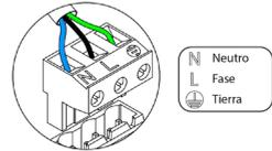
**Importante:** En el cableado de alimentación externo del sistema deberá incorporarse, según la reglamentación local y nacional pertinente, un interruptor principal u otro medio de desconexión que tenga una separación constante en todos los polos. El sistema se reiniciará automáticamente si se apaga la alimentación principal.
