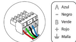
**Nota:** Para elementos con alimentación externa a 110/230 Vac, sólo es necesario conectar los polos "A" y "B" del bus para las comunicaciones.
