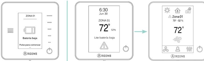
Para sustituir la batería, separe el termostato de su soporte y sustituya la batería (CR2450).
