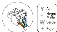
**Recuerde:** La longitud máxima recomendada para la conexión del módulo con el termostato es de 10 m (33 ft).
