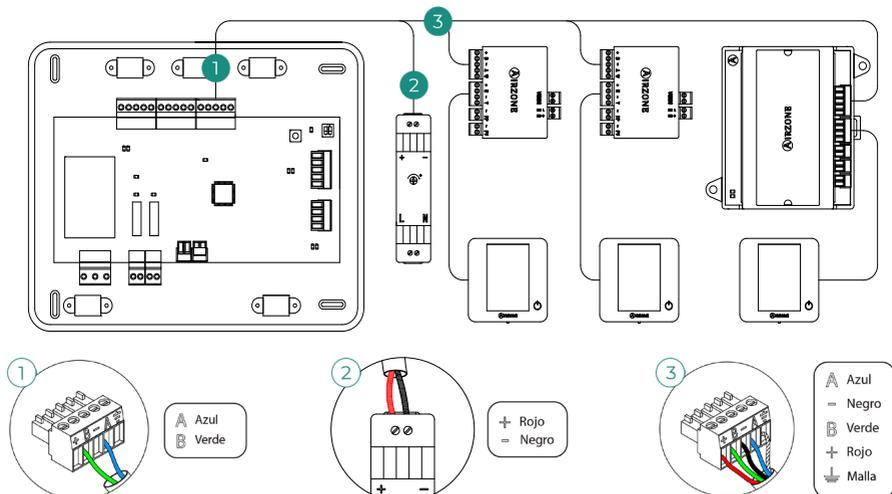
**Nota:** No conecte el polo "-" en la borna "+". Puede dañar el dispositivo.
