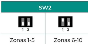
**Por ejemplo:** el relé para controlar el elemento radiante de un módulo con dirección 6 es el R1 del módulo de control de calefacción radiante con la dirección configurada para las zonas 6-10.
