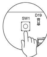
**Reset del sistema:** En caso de que necesite devolver el sistema a los valores de fábrica, mantenga pulsado SW1 hasta que el LED D19 deje de parpadear. Espere 60 segundos para que el sistema se reinicie totalmente antes de volver a configurarlo.
