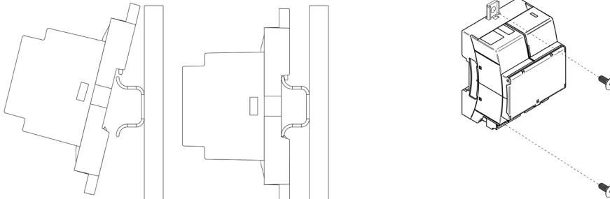
**Note :** Pour retirer le module du rail DIN, tirez la languette vers le bas pour l'extraire de celui-ci.
