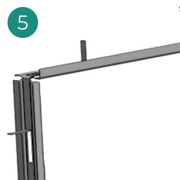
**(PT) ARMAÇÃO DE CHAPA GALVANIZADA PARA ESTRUTURA DE MONTAGEM DE GRELHA**
