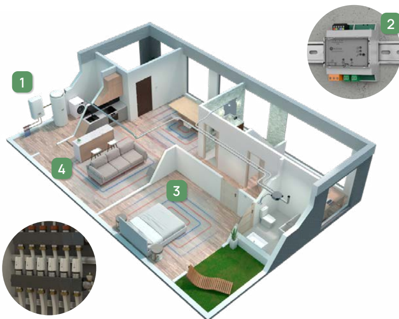
1. Διαχείριση παραγωγής. 2. Διαχείριση συμπυκνωμάτων. 3. Ενδοδαπέδια ψύξη 4. Έως και 8 ζώνες.
