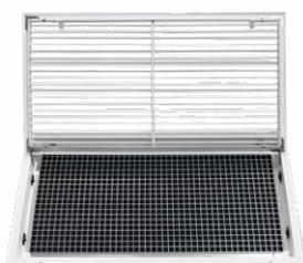
Grille de diffusion RRFR en aluminium extrudé avec cadre standard de 26 mm et lames horizontales mobiles, réglables de manière individuelle, ce qui permet d'adapter la portée et la veine d'air aux besoins spécifiques.
