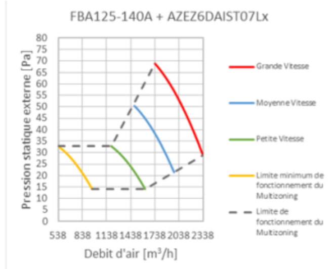
Figure 8 – Unités intérieures FBA125A et FBA140A Courbes débit/pression
