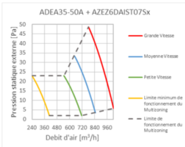
Figure 9 – Unités intérieures ADEA35A et ADEA50A Courbes débit/pression
