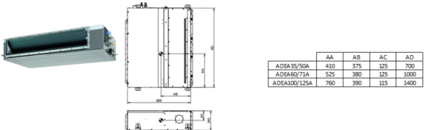
Figure 2 – Unités intérieures ADEA35/50/60/71/100/125A – Visuel et caractéristiques dimensionnelles
