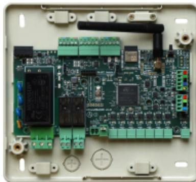
Figure 4b – Contrôleur central - AZPV8CB1IAQ
