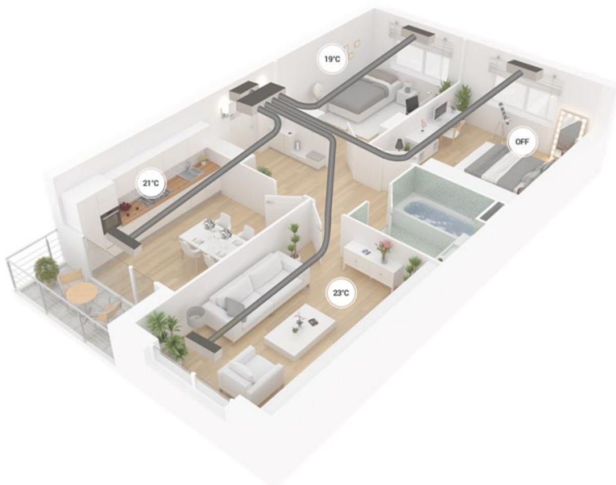
Figure 1 – Schéma de principe du système « Gainable Toshiba - Multizoning Airzone - Anjos »
