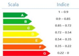
**Figura 11.** Classificazione del comfort in base all'Indice di comfort (IC)
