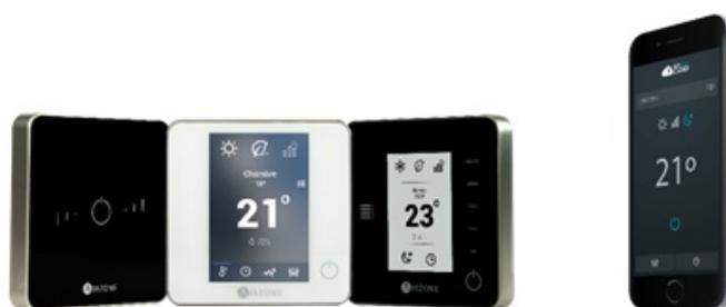
Depuis nos interfaces il est possible de contrôler la température, réaliser des programmations horaires, changer le mode de fonctionnement, accéder au service de prévision météo et autres fonctionnalités.
